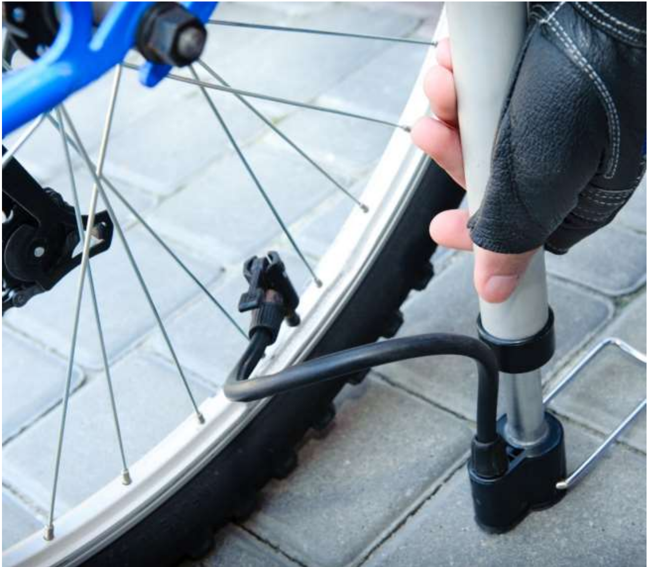
Fig. 3; Een fietspomp wordt warm door het samendrukken van lucht.
